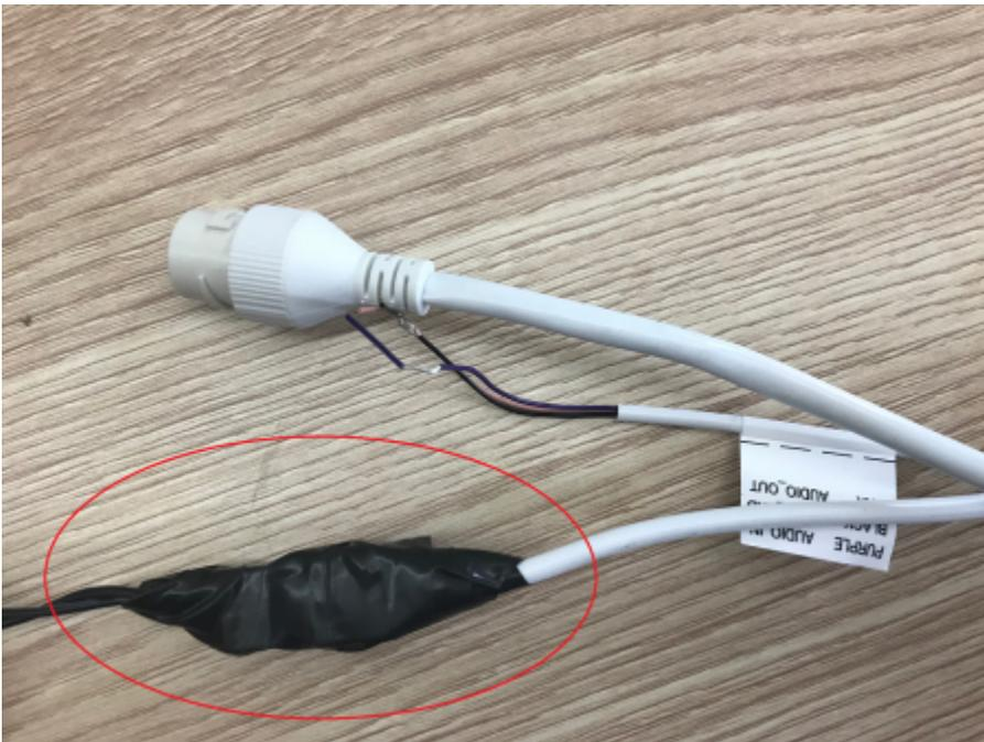
3. 使用绝缘胶带对其它线缆（裸线）做好绝缘防护。
