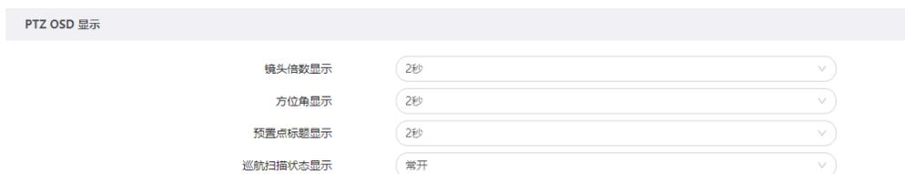
云台可在实时感知画面上显示镜头倍数、方位角、预置点标题、巡航扫描状态信息，可根据需要选择显示的持续时间。
